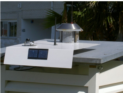
Fig. 4. Fase de Montaxe exterior con Antena, Piranómetro e Células Solares
