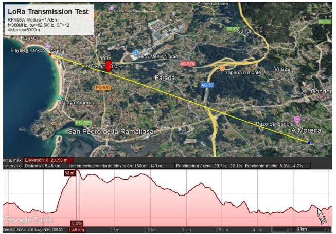
Fig. 4. Perfil de elevación y distancia alcanzada en modo LoRa.
